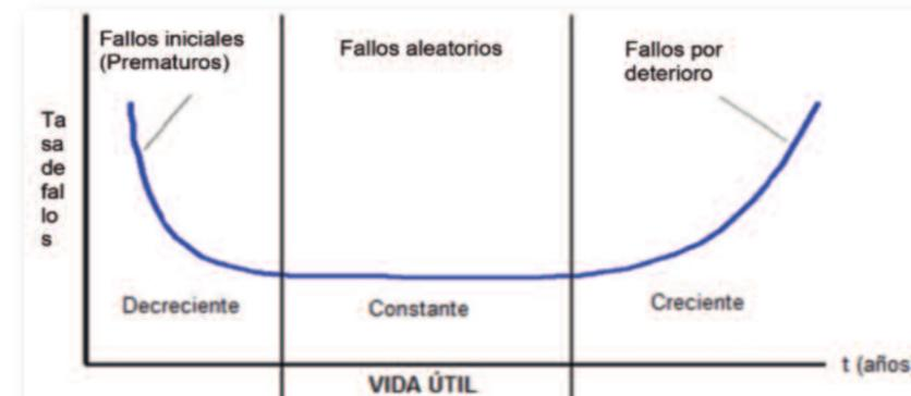
Figura 1: Tradicional “curva de la bañera” para las probabilidades de fallo durante la vida útil del equipo [1]
