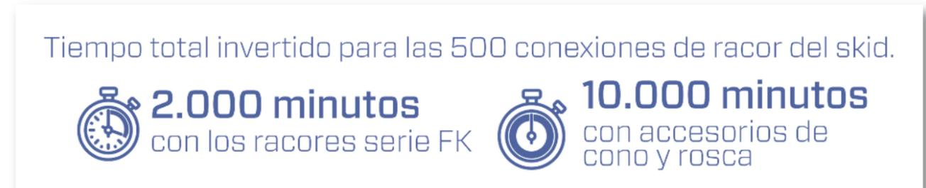
Figura 3. Los instaladores pueden montar los racores de compresión Serie FK aproximadamente cinco veces más rápido que los racores con cono y rosca. Imagen © Swagelok Company 2020
