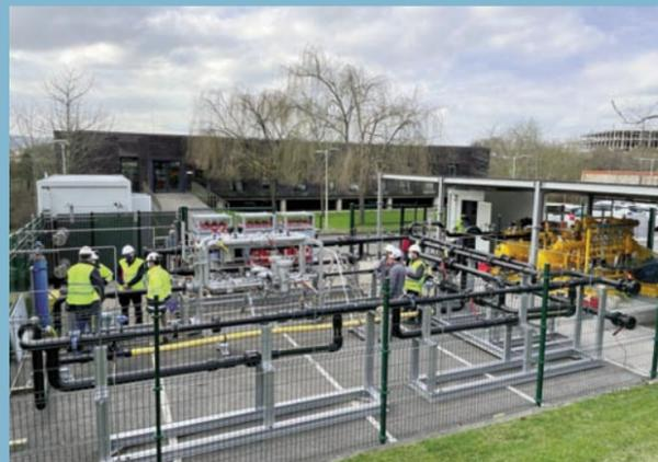
Nortegas ha finalizado con éxito la segunda fase de pruebas de su proyecto H2SAREA, en la que ha inyectado una mezcla del 10 por 100 de hidrógeno y 90 por cien de gas natural durante 3.000 horas en una réplica de la red de distribución de gas natural actual, con elementos reales de la red de distribución que llevan más de 20 años en operación, incluyendo las instalaciones de usuario doméstico.
