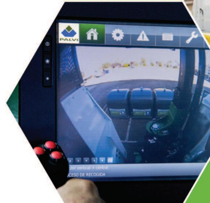
Una vez que el operador ha definido el lado sobre el que quiere operar, el sistema posiciona automáticamente la unidad de movimiento y procede al enganche, elevación y descarga del contenedor determinando la apertura del fondo del mismo. Finalizada la operación, devuelve el contenedor a su posición original.
