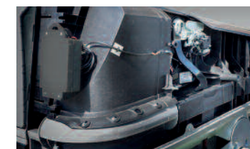
Cierre ACL integrado en el lateral del contenedor. Patentado
