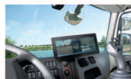
Pantalla táctil panorámica frontal con joystick multifunción
