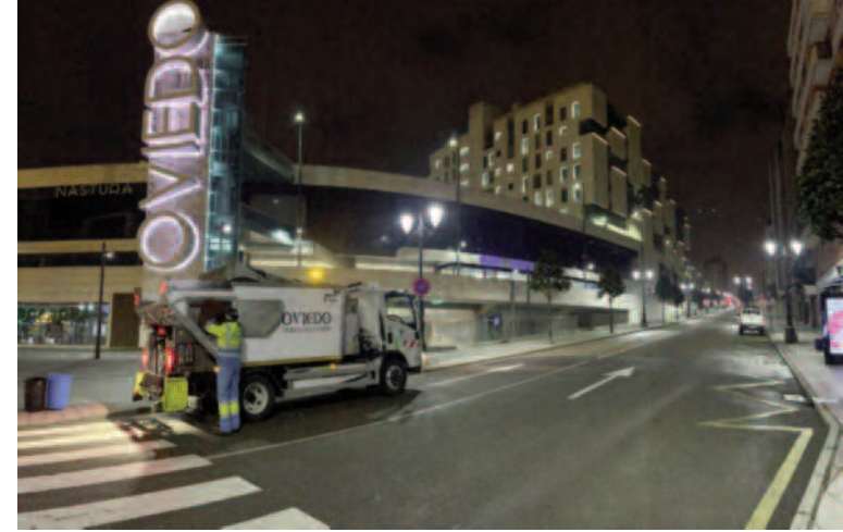
Recogida orgánica con recolector eléctrico de 7 metros cúbicos
