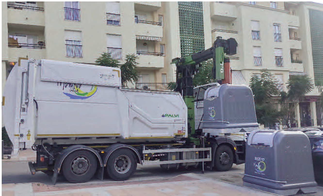
Recogida selectiva de residuos con sistema bilateral automático de Palvi, en Manilva
