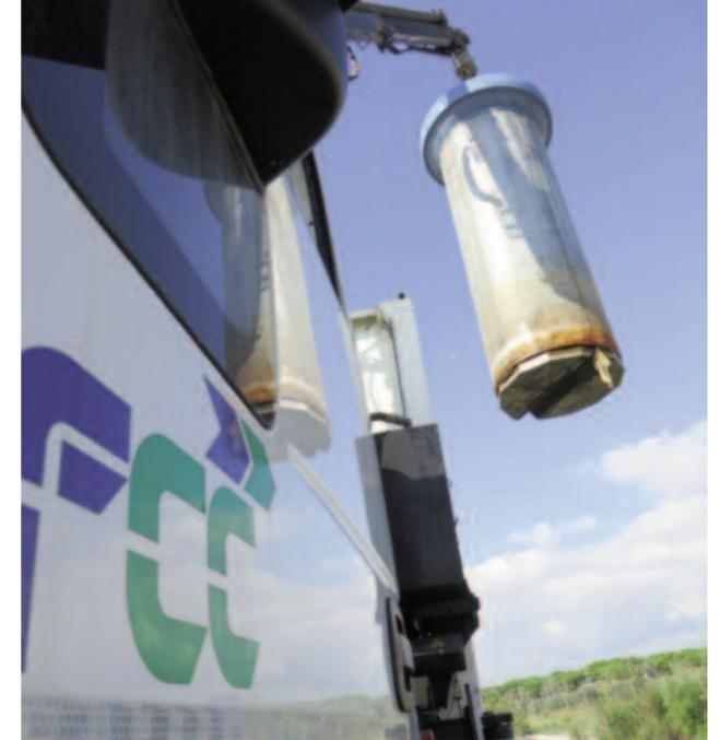
Equipo de vaciado de papeleras semisoterradas de 1.800 litros
