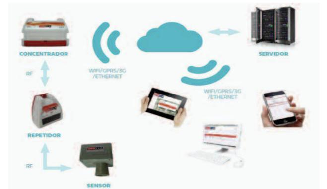
Sistema de comunicación sensores de llenado de papeleras
