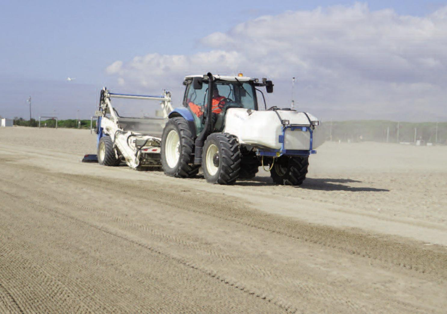
Limpeza mecánica con cribadoras
