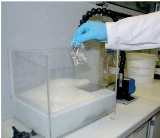
La nueva solución de antiespumante Bonderite, basada en glicoles y compuestos tensioactivos, permite un uso seguro y limpio de los productos químicos sin que entren en contacto directo con la piel. El empaquetado especial en mini bolsitas solubles en agua permite una dosificación precisa.
