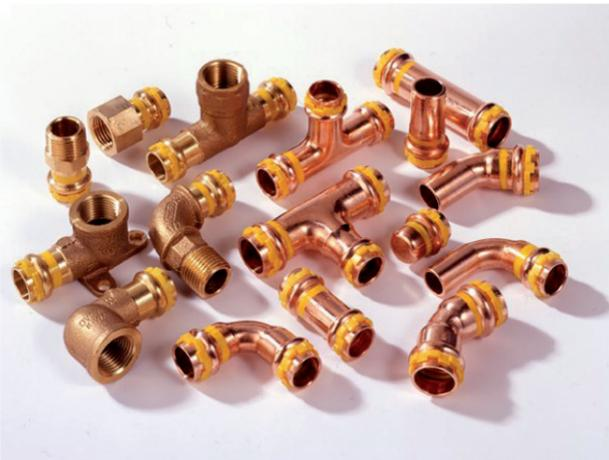
La gama SkinPress Gas está disponible desde 15 mm hasta 54 mm. Junta tórica de estanqueidad en HNBR de gran calidad, según NF-EN 549 y EN 682. Los tubos de cobre utilizables deben cumplir la norma UNE-EN 1057. Esta norma define tanto las características mecánicas del tubo de cobre, así como sus medidas y tolerancias.
