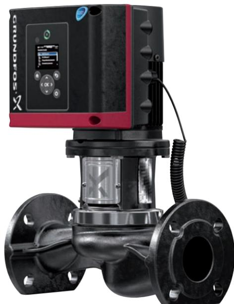
tegrado puede ahorrar el coste de un sensor diferencial de temperatura. Además será capaz de hacer funcionar la bomba en base a la diferencia medida entre la temperatura del caudal y la temperatura de retorno. Esto se realiza mediante un sensor externo conectado directamente a la TPE3, por lo que permite a la bomba controlar las necesidades de caudal del sistema basado en la temperatura diferencial.
