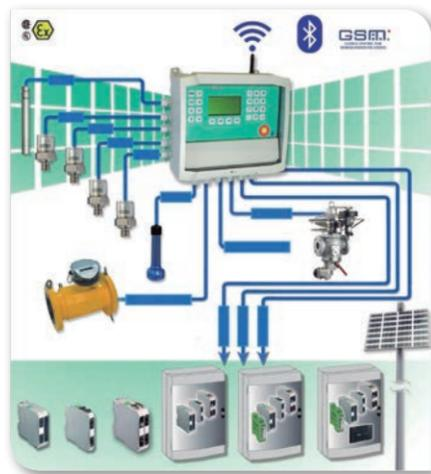
Gestiona hasta seis señales digitales y dos líneas de regulación. Esta nueva tecnología permite la integración con los sistemas de gestión global de la energía (SCADA, OPM, ...), la adecuación de las redes para reducir los niveles de fugas cuidando nuestro entorno y la optimización de la distribución de presiones, asegurando la calidad del suministro a los clientes.
