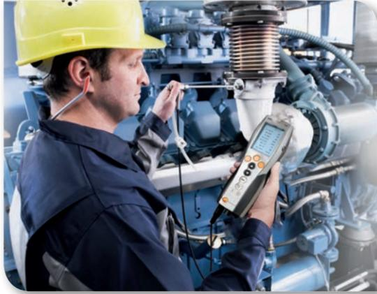
concentraciones de hasta un máximo de 50.000 ppm de CO, un máximo de 20.000 ppm de NO) o un máximo de 25.000 ppm de SO<sub>2</sub> sin sobrecargar el sensor.
