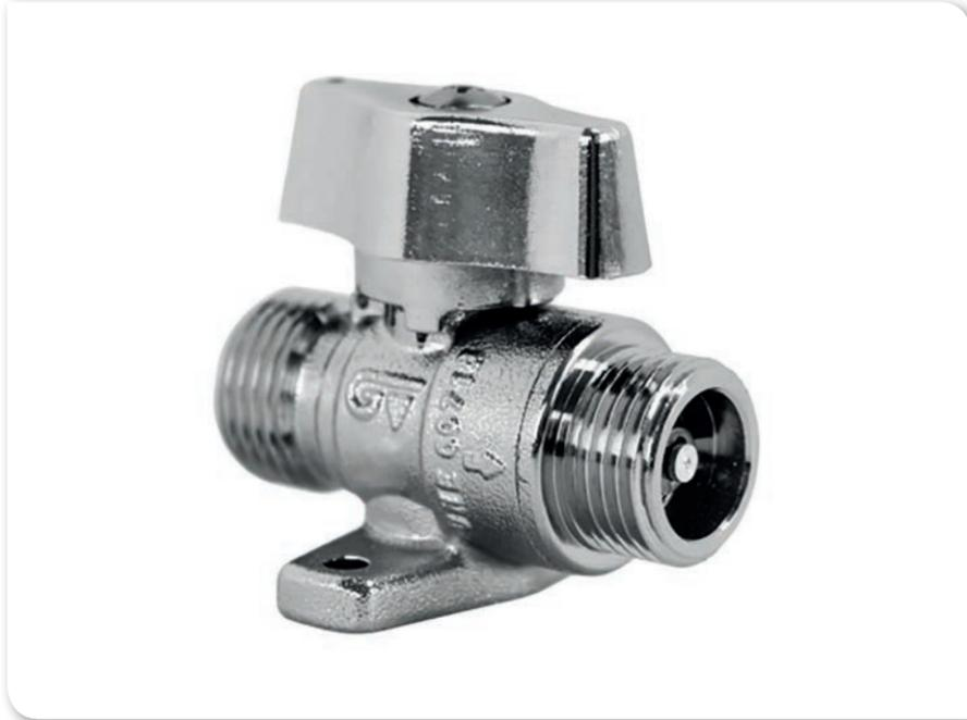
Genebre presenta la nueva válvula recta para gas con autobloqueo y limitador de caudal incorporado. Tiene como objetivo interrumpir el caudal por una demanda excesiva o en caso de anomalía accidental en la instalación, evitando la formación de una atmósfera explosiva. Se trata de la primera válvula de gas con autobloqueo y limitador de caudal con certificación de producto AENOR.
