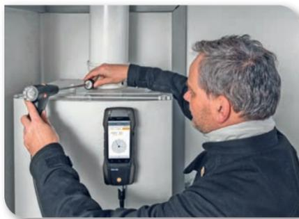
–Sensores de alta calidad: Equipado de serie con sensor de O<sub>2</sub> y con sensor de CO compensado en H<sub>2</sub> hasta 8.000 ppm
